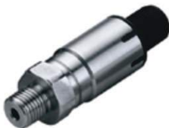
TRANSMISSOR DE PRESSÃO Os transmissores de pressão compactos da série 510 foram projetados, principalmente, para aplicações industriais de refrigeração. A concepção do sensor permite o seu uso em qualquer gás ou meio refrigerante, incluindo amônia. O produto foi projetado para suportar pressões entre 0 e 120 bar.
