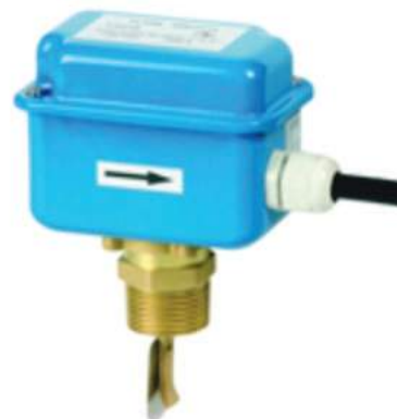
CONTROLADOR VAZÃO "FLOW PEN" Controlador de vazão "FLOW PEN" caixa plástica em ABS. Conexão latão. Jogo de linguetas em aço inox AISI 316. Temp máx. 120°C. Pressão máx 10BAR 20A 220V 50HZ proteção IP- 64 Rosca 1"
